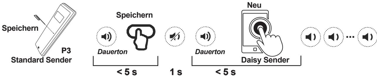
Drücken Sie die Taste P3 des gespeicherten Standardsenders und halten Sie sie gedrückt. Der Summer gibt einen Dauerton ab. Drücken Sie eine Taste zu einem bereits gespeicherten Code. Der Summer stoppt 1 Sekunde lang und startet dann den Dauerton erneut. Drücken Sie die virtuelle Taste am Daisy-Sender in Bezug auf den neuen Code, der gespeichert werden soll. Das erfolgreiche Speichern wird durch das intermittierende Geräusch des Summers angezeigt.
