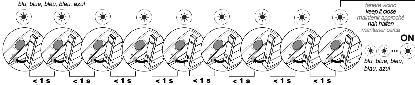
IT - Avvicinare il magnete di programmazione al sensore **9 volte** e tenere vicino.EN - Get the programming magnet close to the sensor **9 times** and keep it close.FR - Approcher l' aimant de programmation à le capteur **9 fois** et le maintenir approché.DE - Nähern Sie sich **9-mal** dem Sensor mit dem Programmiermagnet und halten Sie diesen nah an den Sensor.ES - Acercar el magneto de programación al sensor y manténgalo cerca para **9 veces**.
