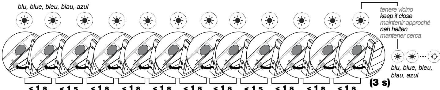
**IT** - Avvicinare il magnete di programmazione al sensore **12 volte** e tenere vicino.
