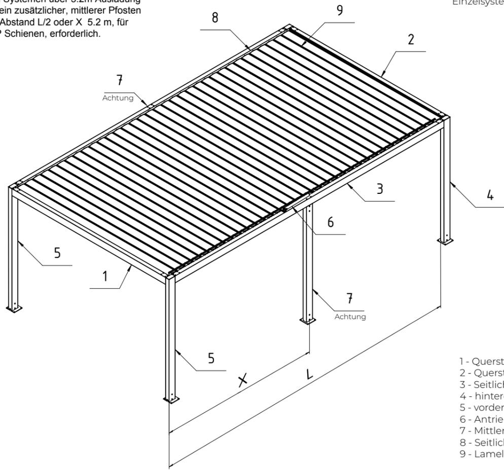
Einzelsystem mit mittleren Pfosten
