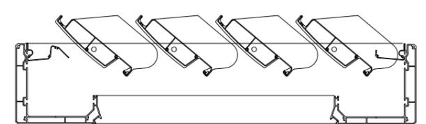
Rotation der Lamellen um 0°, 45°, 90° und 140° voreingestellt auf 4 Tasten der Fernsteuerung; Möglichkeit der Zwischeneinstellung über die drei Tasten der Fernsteuerung: öffnen, stoppen und schließen
