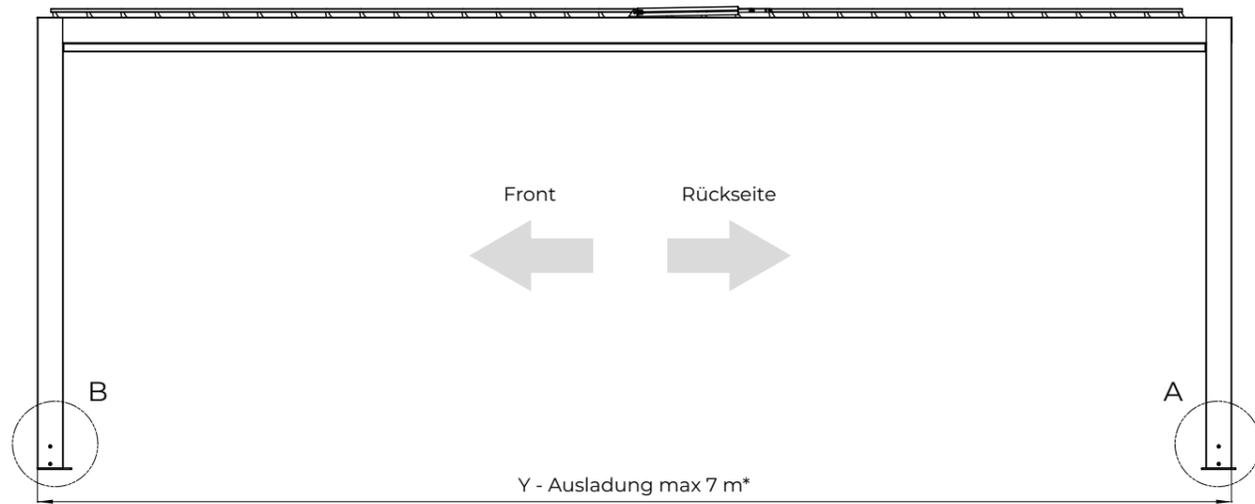
\* über 5.2m Ausladung ist ein zusätzlicher Pfosten für ZIP Schienen erforderlich
