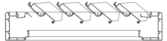
Rotation der Lamellen um 0°, 45°, 90° und 140° voreingestellt auf 4 Tasten der Fernsteuerung; Möglichkeit der Zwischeneinstellung über die drei Tasten der Fernsteuerung: öffnen, stoppen und schließen.
