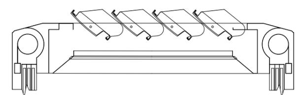
Rotation der Lamellen um 0°, 45°, 90° und 140° voreingestellt auf 4 Tasten der Fernsteuerung; Möglichkeit der Zwischeneinstellung über die drei Tasten der Fernsteuerung: öffnen, stoppen und schließen.
