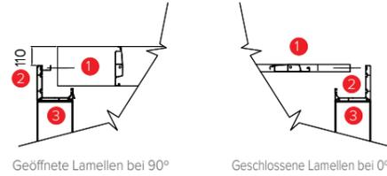
Geöffnete Lamellen bei 90°      Geschlossene Lamellen bei 0°
